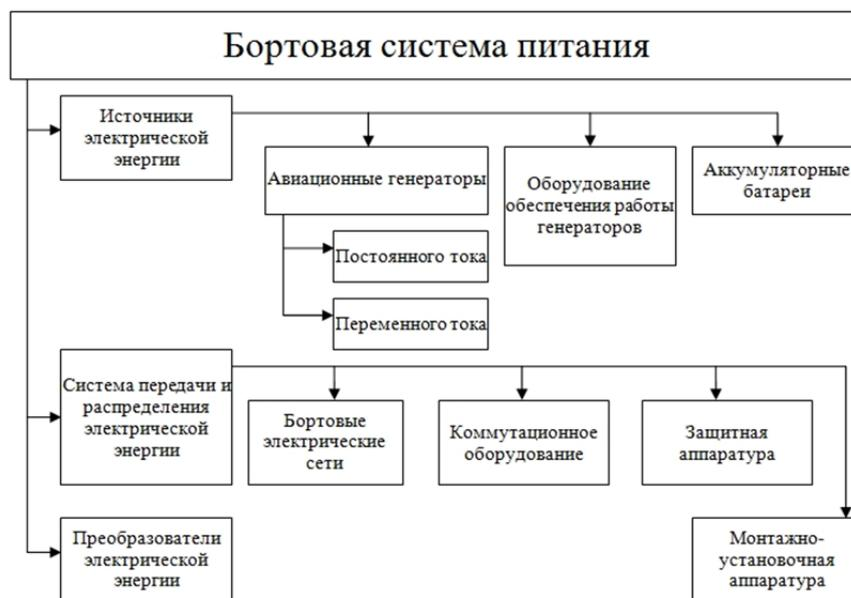
Рис. 1. Структурная схема бортовой системы питания
